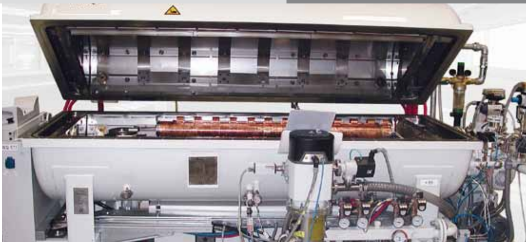
Ultrahochvakuum-Glühöfen ▶ „Box in Box“ System
