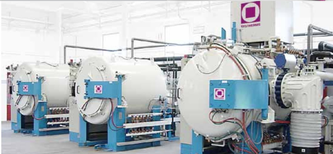
Vakuum-Härte- und -Anlassöfen ▶ Typ VA + VWC
